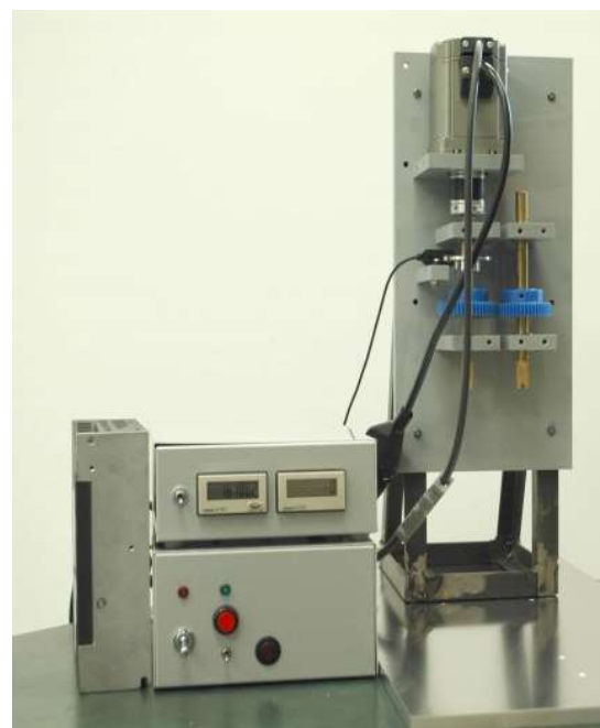
極細金属線の疲労特性評価装置の作製。
